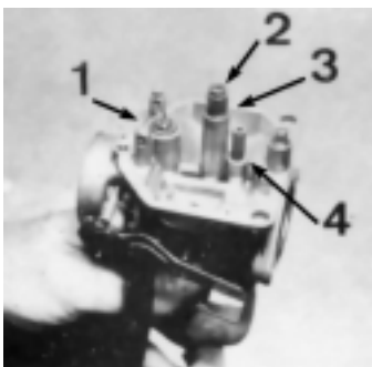
(1) VÁLVULA DA CUBA (2) GICLÊ PRINCIPAL (3) PULVERIZADOR (4) GICLÊ DE MARCHA LENTA
